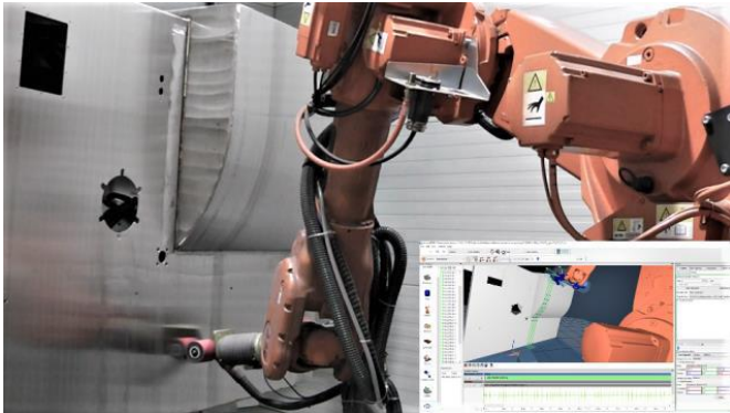
Półautomatycznie programowane szlifowanie dużych części w wąskim komórki z dodatkowymi osiami.
